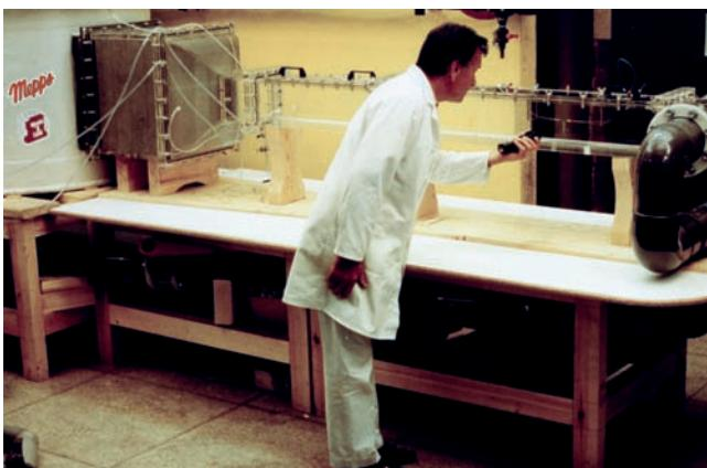
Labo Mepps. Banc d'essai des prototypes : Canal à eau à veine horizontale avec vitesse d'écoulement variable.
